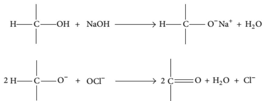
Специалисту в данной области техники хорошо известно, что обработка крахмала гипохлоритом натрия приведет к окислению крахмала и таким образом приведет к разрушению молекулы крахмала, что снижает молекулярный вес крахмала с последующим снижением его вязкости. Окисление гипохлоритом натрия немного стабилизирует крахмал в зависимости от ретроградации[4].
