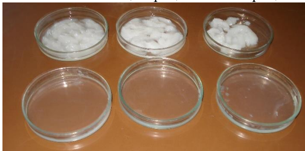
Рис.1. Охлажденные гидрогели окисленного (нижний ряд) и нативного (верхний ряд) кукурузного крахмала (полученные из 5, 6, 7 % ных клейстеров)
