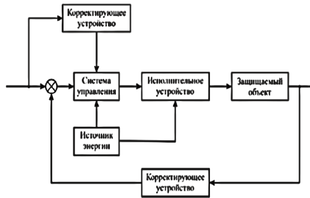
Рис.4. Структурная схем метода активной виброзащиты.
