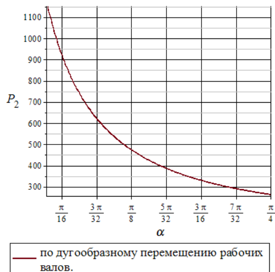
Рис. 2. Зависимость изменения влияния силы тяжести P_2 рабочих валов от угла захвата \alpha
