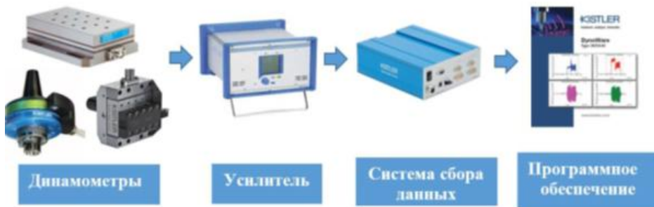
Рис. 7. Общая схема подключения динамометра Kistler
