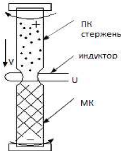
1-rasm. Tigelsiz kremniyni eritish qurilmasi sxemasi.
