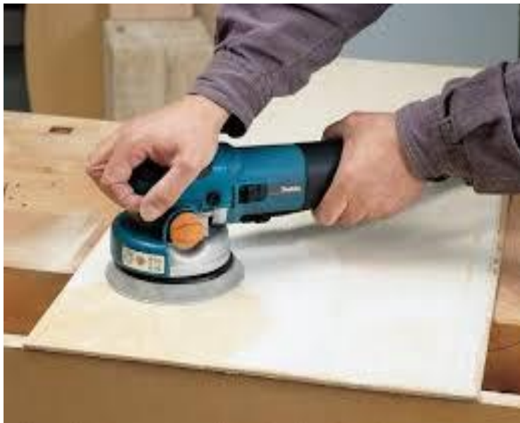
6-rasm. Yog'och materiallar yuzasini pardoqlashga tayyorlash.
