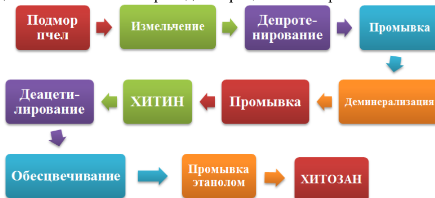
Рис.1. Схема синтеза аминополисахарида хитозана
