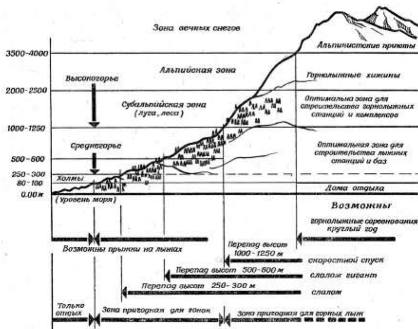
Рис. 52. Схема пригодности рельефа для различных видов лыжного спорта. Базы для массового катания рекомендуется размещать в зонах
