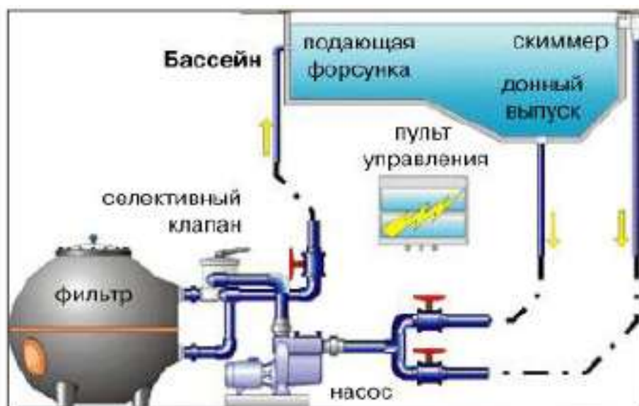
рис.74а Технологическая схема плавательного бассейна скиммерного типа
