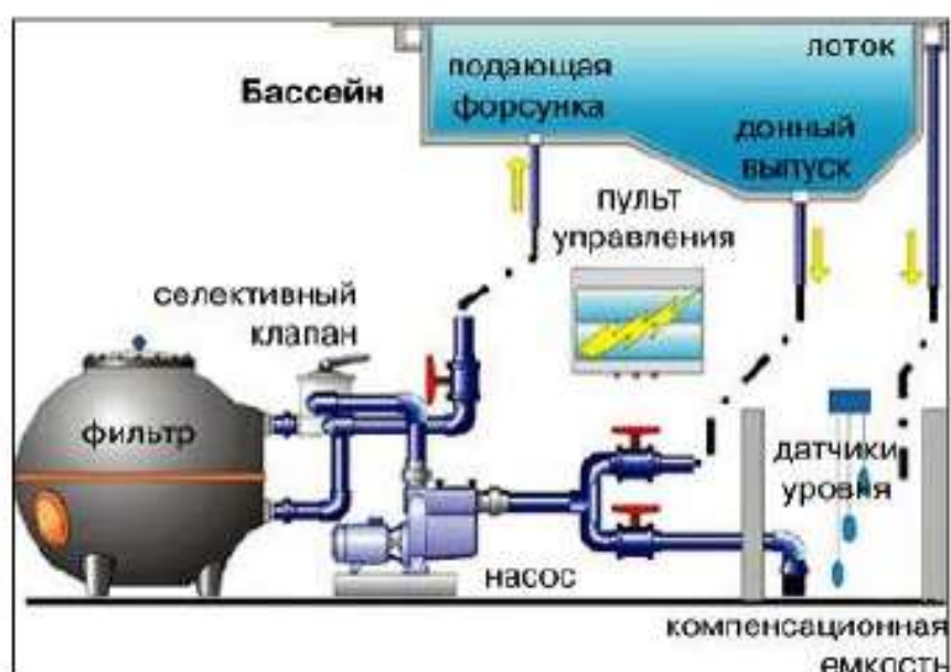
рис.74б Технологическая схема плавательного бассейна переливного типа
