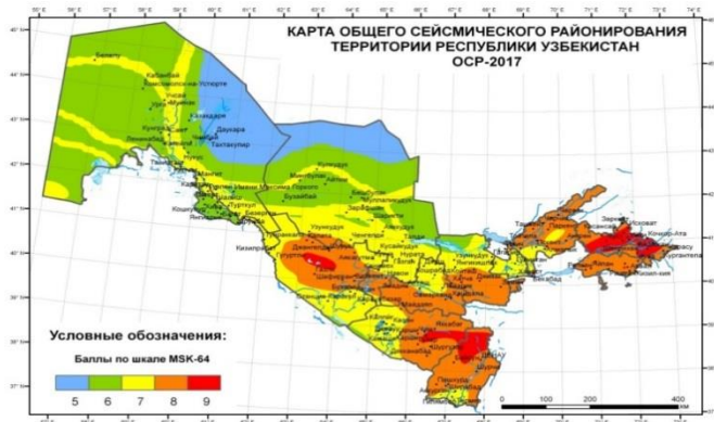
Расм 1. Ўзбекистон Республикасининг умумий сейсмик районлаштириш харитаси (Муаллифлар: Т.У. Артиков, Р.С.Ибрагимов, Т.Л.Ибрагимова ва М.А.Мирзаев).
