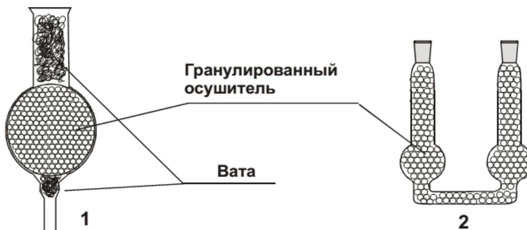
**Рисунок 6.** Осушительные трубки: **1** - хлоркальциевая трубка с одним шаром; **2** - U-образная трубка (обычно используется для осушки потока газа)
