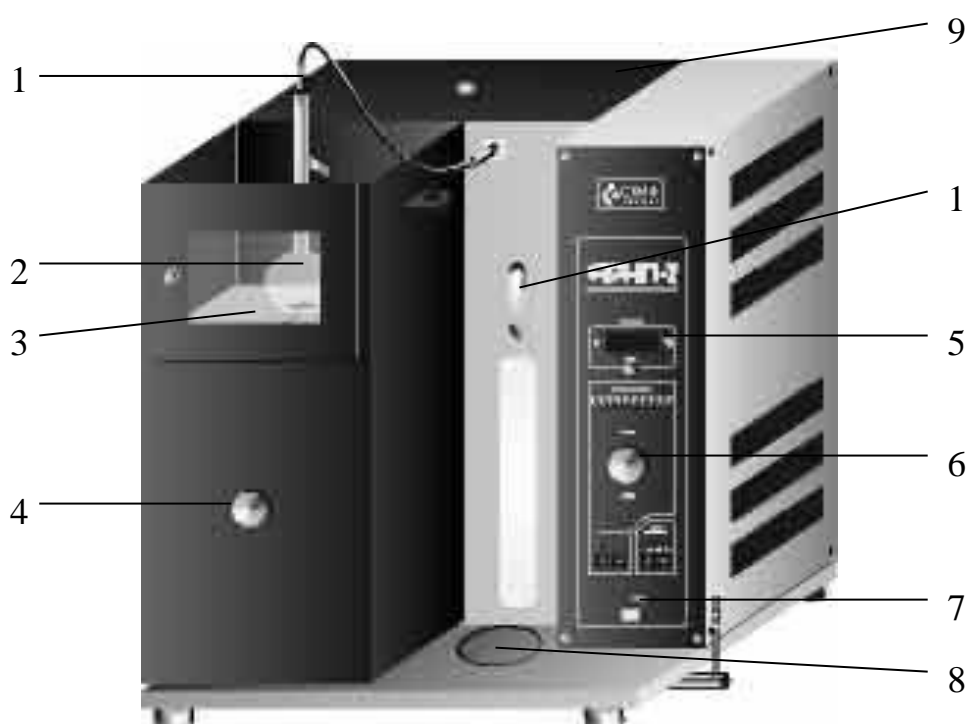
Рис.1. Аппарат для перегонки АРНП-2: 1 – термомпара; 2 – колба для перегонки; 3 – электрический нагревательный элемент; 4 – ручка для регулирования положения колбы; 5 – индикатор температуры; 6 – диск для регулирования нагрева; 7 – выключатель; 8 – подставка для установки мерного цилиндра; 9 – охлаждающая баня; 10 – трубка холодильника.
