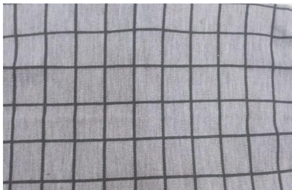
Рисунок 1. Разработанный прототип электропроводящей ткани
