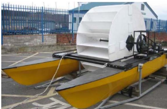
Рис. 3. а) внешний вид, б) график зависимости коэффициента использования воды и коэффициента быстроходности поплавковой гидроустановки водяного колеса разработанной С.Р. Турноком.
