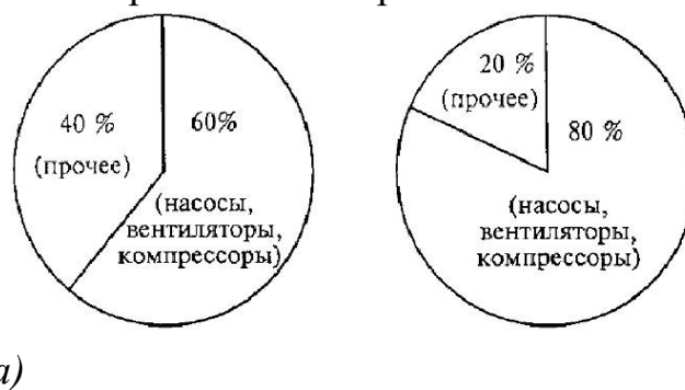
Рисунок 1 – Потребление электроприводом электроэнергии в ЕС (а – промышленный сектор, б – коммерческий сектор)
