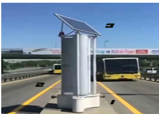
1 – rasm. 1 – Taglik 2 – Shamol parraklari va ustunlari 3 – Quyosh paneli
