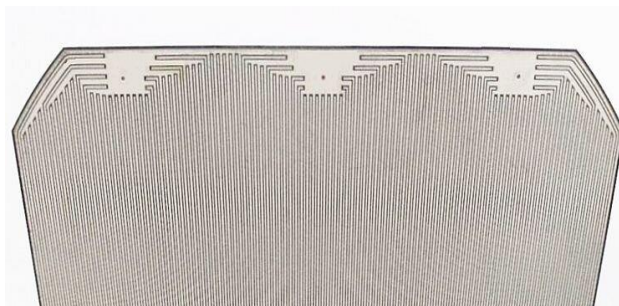
1-rasm. IBC elementining orqayuzasi ko'rinishi.
