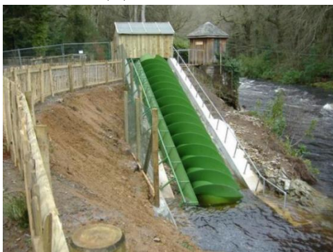
Рис. 2. а) внешний вид и б) энергетические характеристики винтов Архимеда
