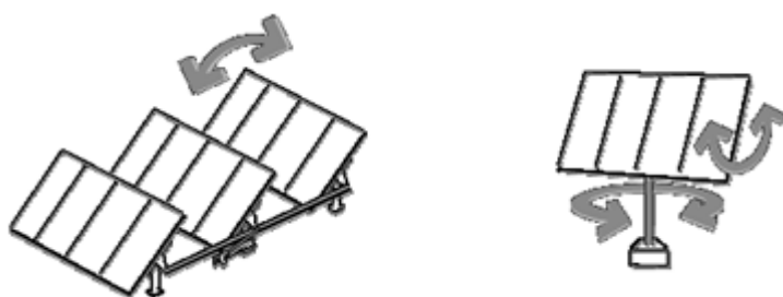
Рис.1. Одноосевые и двухосевые солнечные установки
