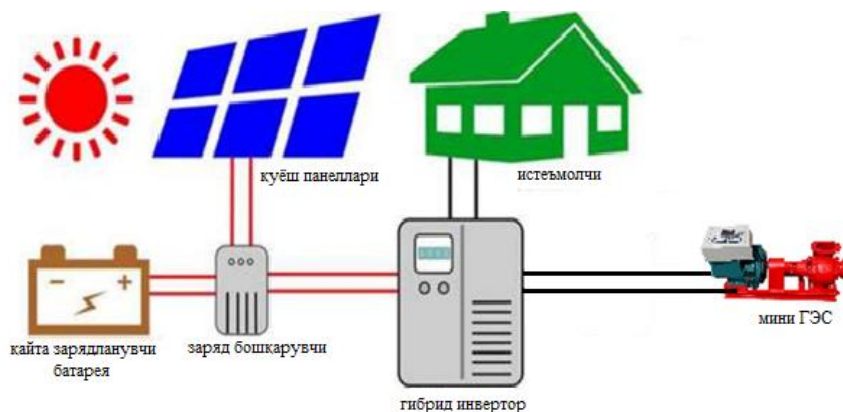
1-расм. Кичик ГЭС ва қуёш панелларини бирлаштирилган схемаси.
