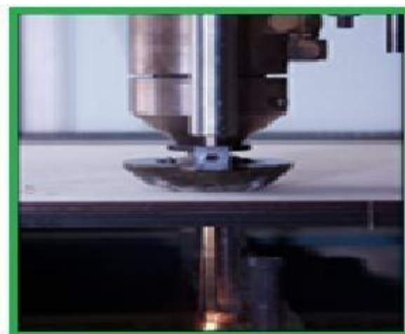
Металларда кичик ўлчамли тешикларни ҳосил қилишда қўлланиладиган лазер
