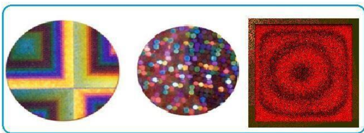
3.17-расм. Деформацияланган жисмнинг голограммаси.
