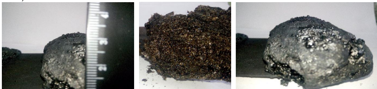
Рисунок 2 – Структура пенококса при содержании аддукта мочевины 30 масс. ч. для азот, фосфор и металлосодержащих олигомеров: ЭД-20 = 70:30 масс. ч.
