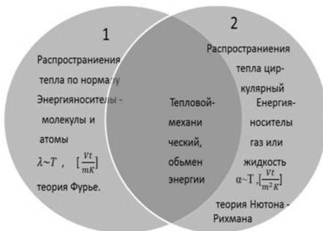
Рис. 1. Диаграмма теплообменов. 1. Теплопроводность. 2. Конвективный теплообмен
