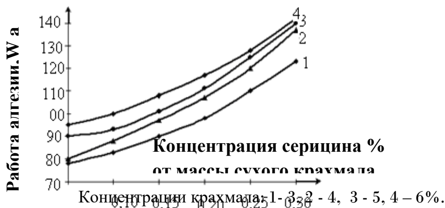
Рис. 1.2. Влияние концентрации серицина на изменение работы адгезии крахмальных шлихт к пряже.
