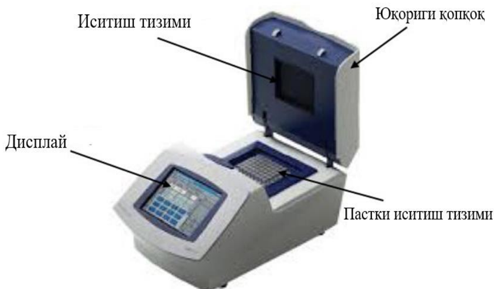
1- rasm. Bio-Rad kompaniyasining T100 Thermal Cycler PZR amplifikatori.
