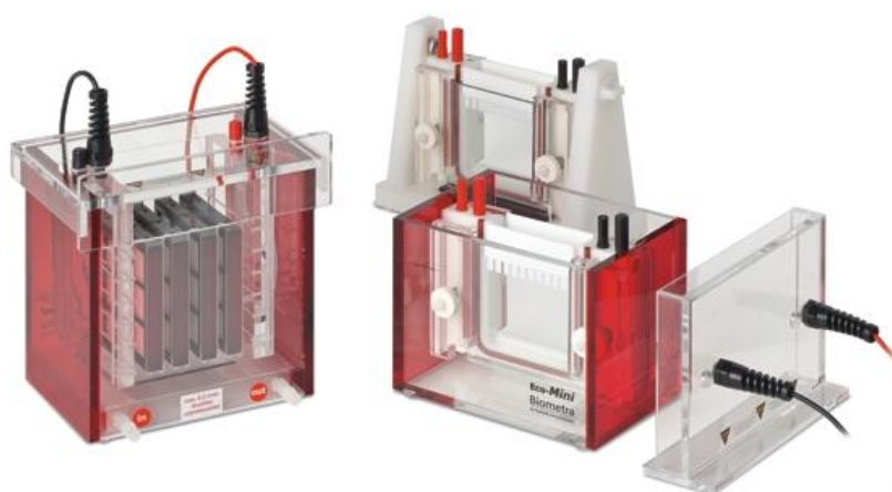
2-rasm. Poliakrilamidli gel elektroforez o'tkazish uskunasi. Eco-Mini sistemasi.
