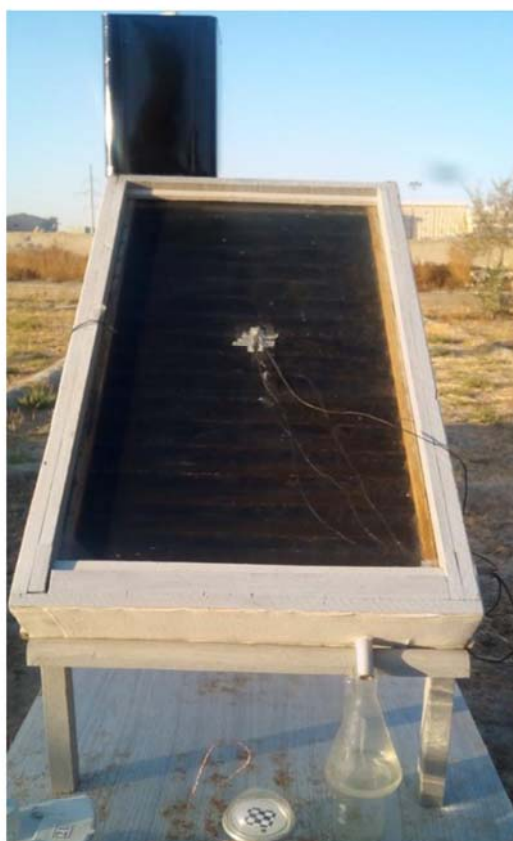
Рисунок 1. Общий вид усовершенствованной наклонной многоступенчатой солнечной установки для опреснения воды
