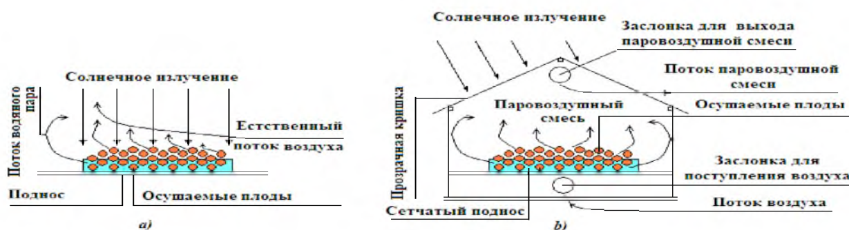
Расм 1. Тўғридан-тўғри қуёш қуритиш қурилмаларининг умумий схемалари
