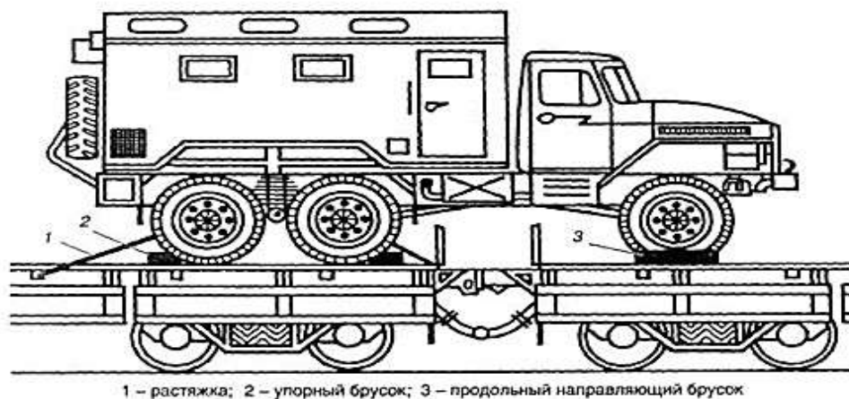
Рисунок 2. Общее крепление автомобиля на платформе
