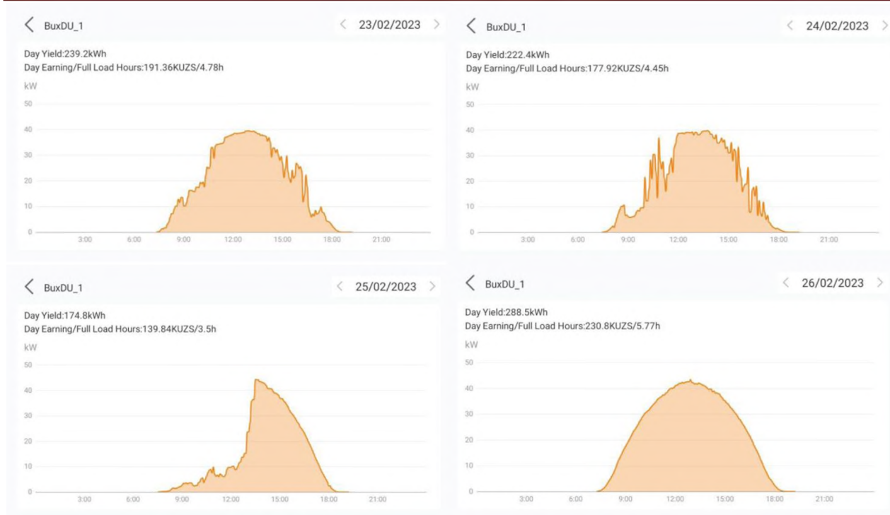
8-rasm. BuxDU bosh binosi tomiga o'rnatilgan 1 invertorning fevral oyida ishlab chiqargan energiya ko'rsatgichlari diagrammasi
