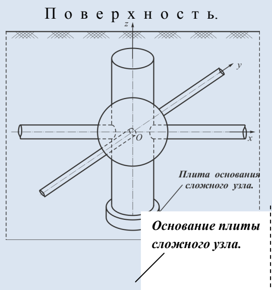
Рис. 1. Расчетная схема сложного узла подземных сооружений
