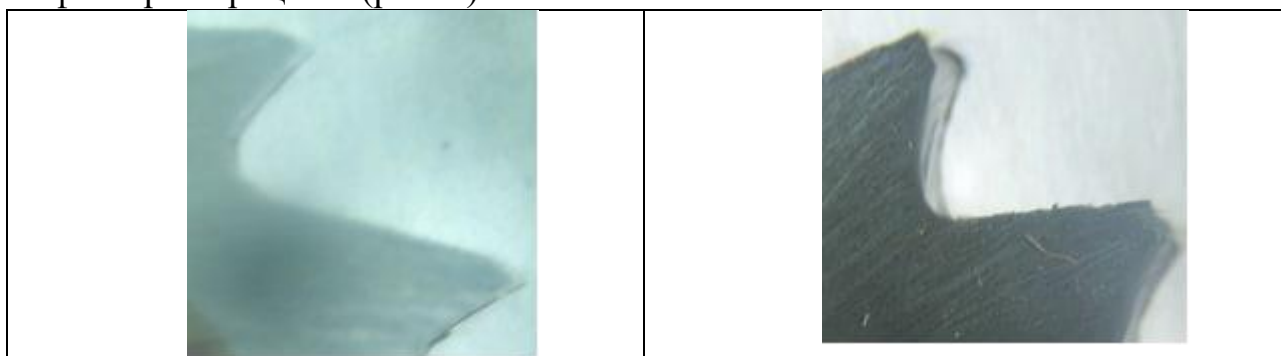
Рис. 1. Радиус округления режущей кромки зуба фрезы после обработки паза длиной 24 см: а) с DLC; б) без покрытия
