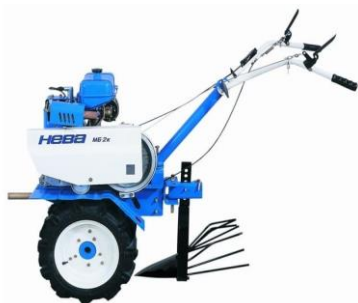
1-расм. Турли хил конструкцияга эга қазувчи ишчи органлари билан жиҳозланган мотоблоклар
