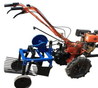
1-расм. Турли хил конструкцияга эга қазувчи ишчи органлари билан жиҳозланган мотоблоклар
