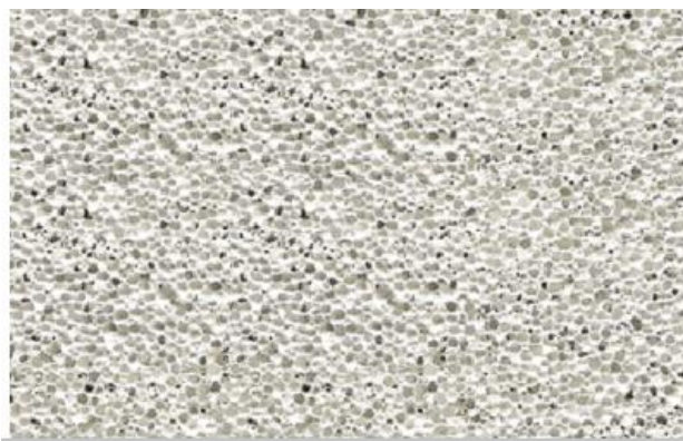
2-rasm. Gaz beton strukturasi.
