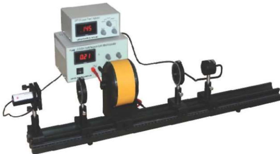
2-rasm. Faraday effektini kuzatish uchun o'rnatishni umumiy ko'rinishi
