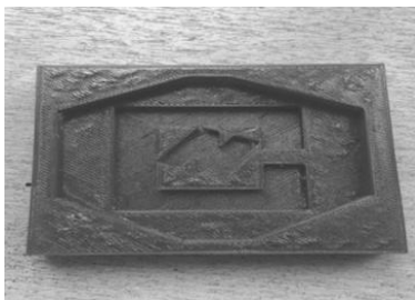
Рис. 1. Мастер-модель для литья эмблемы из гипса, полученная 3D-печатью
