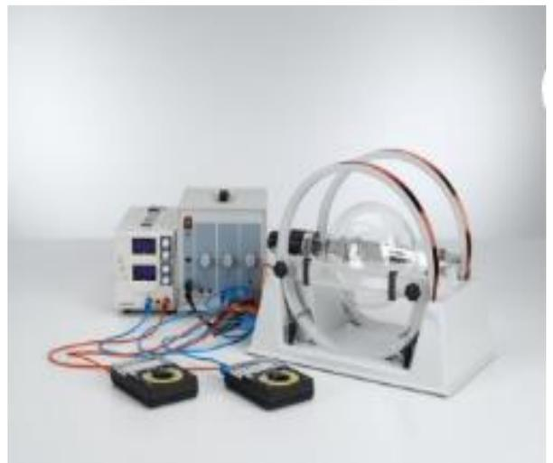
Рисунок 4.5. Экспериментальное устройство для определения удельного заряда электрона.
