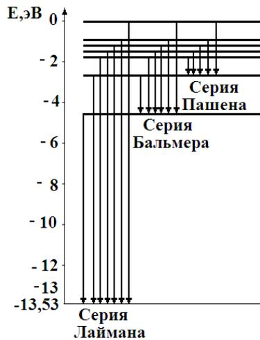
Рисунок 1.6 Энергетические уровни стационарного состояния в атоме водорода.
